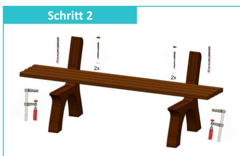
Setzen Sie das Sitzelement auf die Füße auf. Die Einleger in den Aussparungen ausrichten und mit den Schrauben befestigen. (Die Schrauben werden mit O-Ringen unterlegt)
