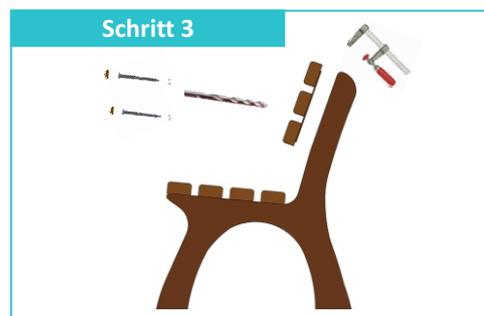
Verfahren Sie bei der Montage der Rückenlehne entsprechend Schritt 2. Die Rückenlehne schließt bündig mit der Oberkante der Bankfüße ab.
